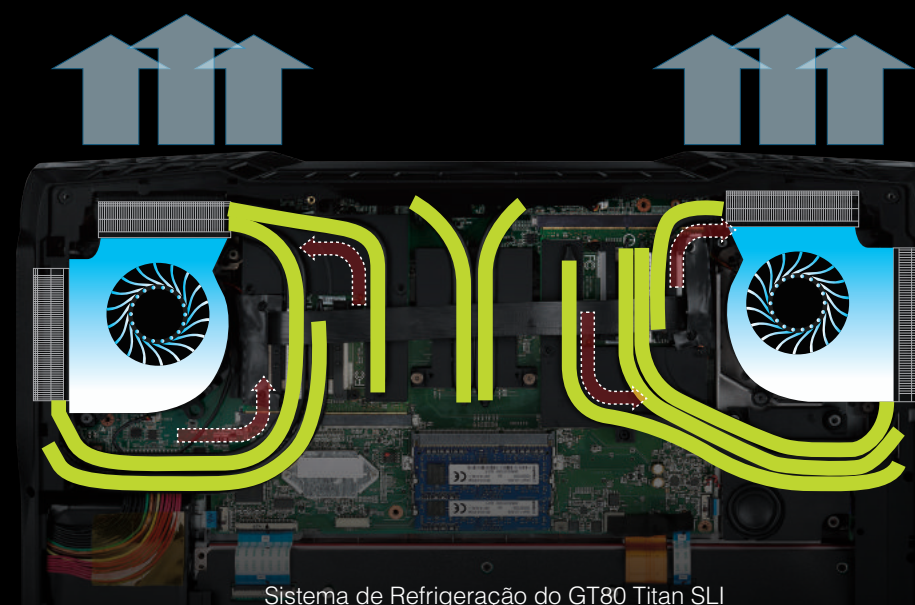
Sistema de Refrigeração do GT80 Titan SLI
